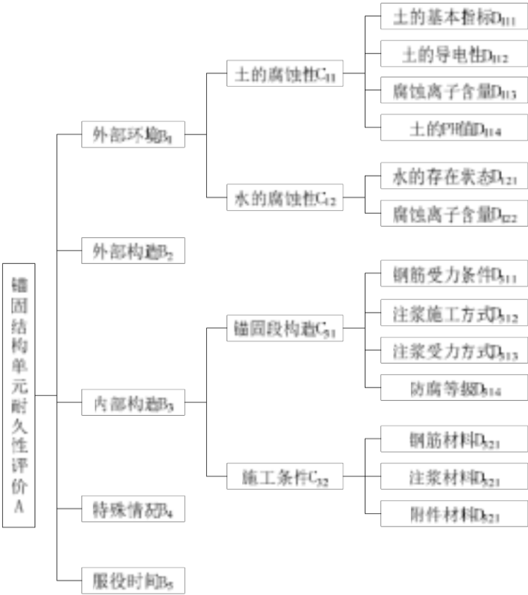
图A. 1 锚固结构构件耐久性评价模型
