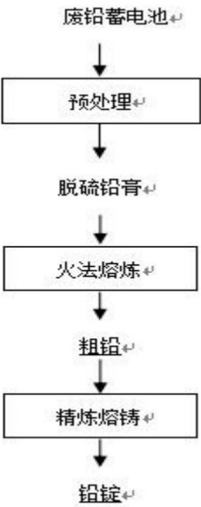
b) 脱硫铅膏还原熔炼-精炼工艺
