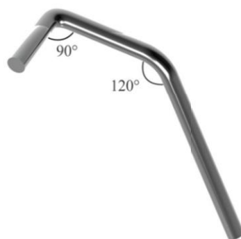
图 F.1 模板支撑杆示意图
