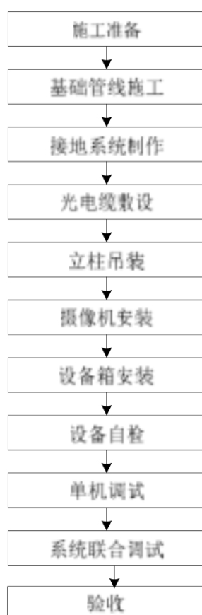
图 5 道路摄像机施工工序
