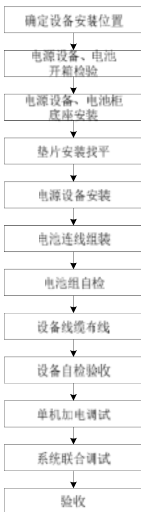
图 22 通信电源施工工序
