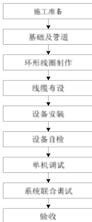
图 14 自动发卡系统施工工序
