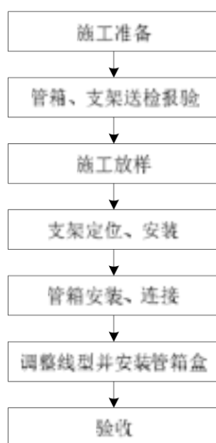
图 26 管箱及支架施工工序
