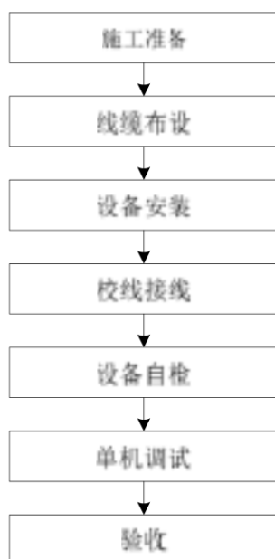
图 10 投包机设备施工工序
