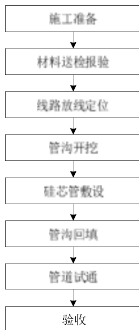
图 27 硅芯管施工工序
