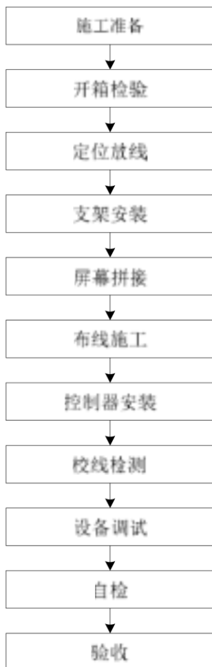
图 2 大屏幕投影系统施工工序
