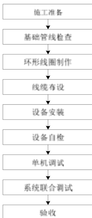
图 12 自动栏杆机施工工序
