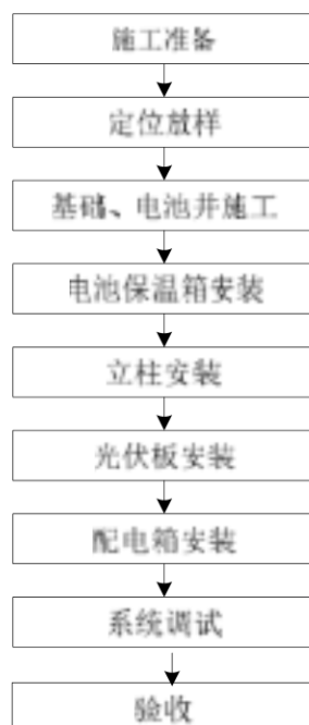
图 9 太阳能供电系统施工工序
