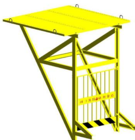
图 6.2.1-1 电梯井操作平台示意图
