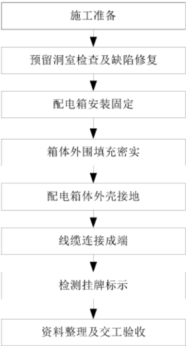
图16 暗装配电箱的施工工序
