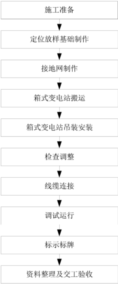
图14 箱式变电站的施工工序
