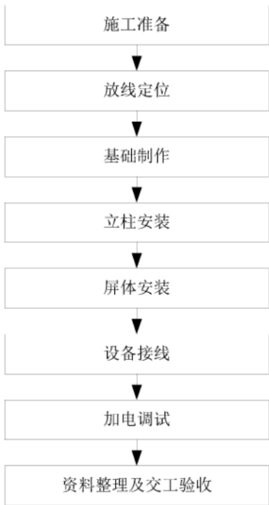
图6 交通信号灯的施工工序
