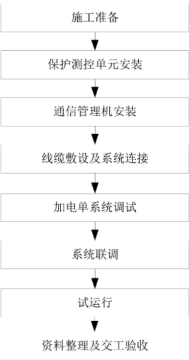
图17 电力监控的施工工序
