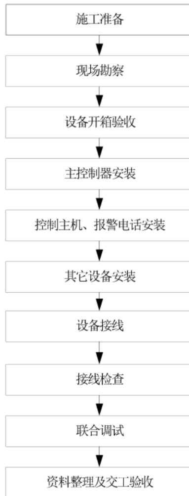
图12 中心控制设备的施工工序
