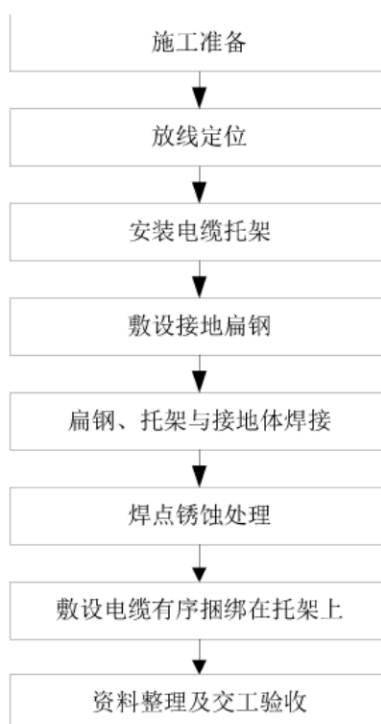
图20 电缆托架的施工工序
