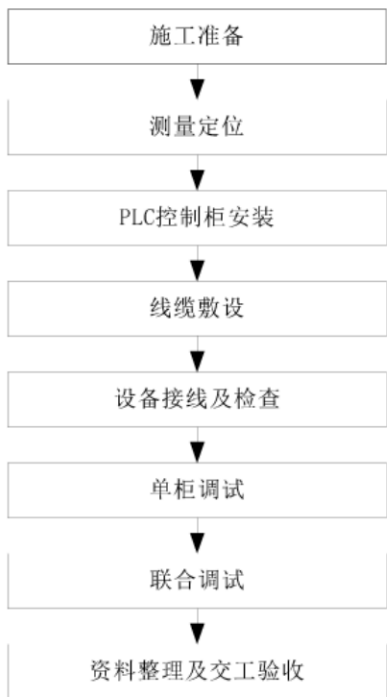
图11 本地区域控制器的施工工序
