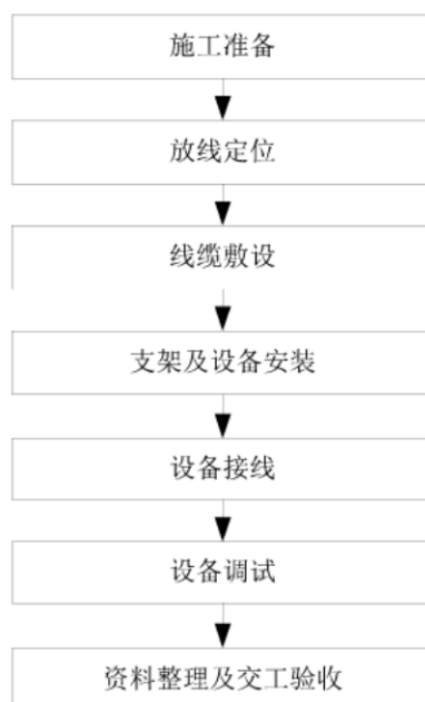
图9 照度计/亮度计的施工工序
