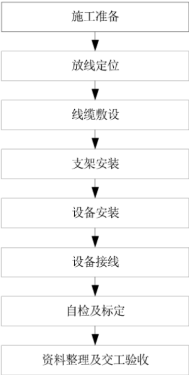
图10 CO/VI、风速风向仪的施工工序
