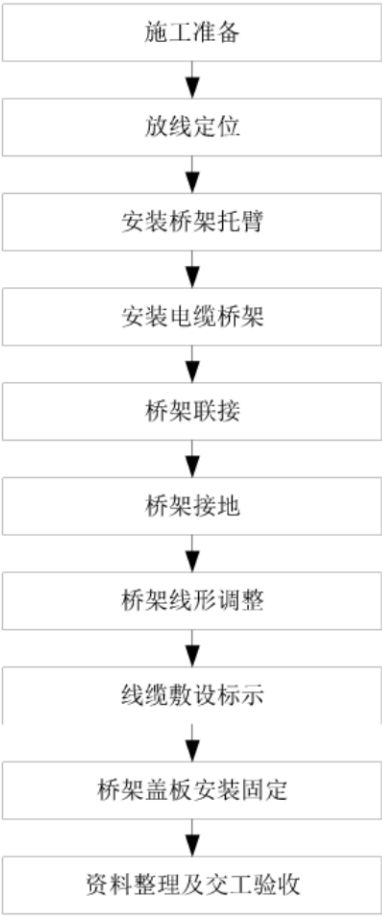
图19 电缆桥架的施工工序
