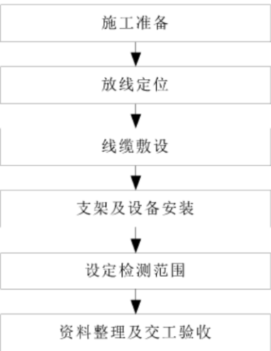
图8 视频事件检测器的施工工序
