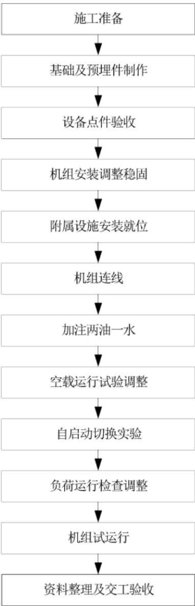
图15 柴油发电机组的施工工序
