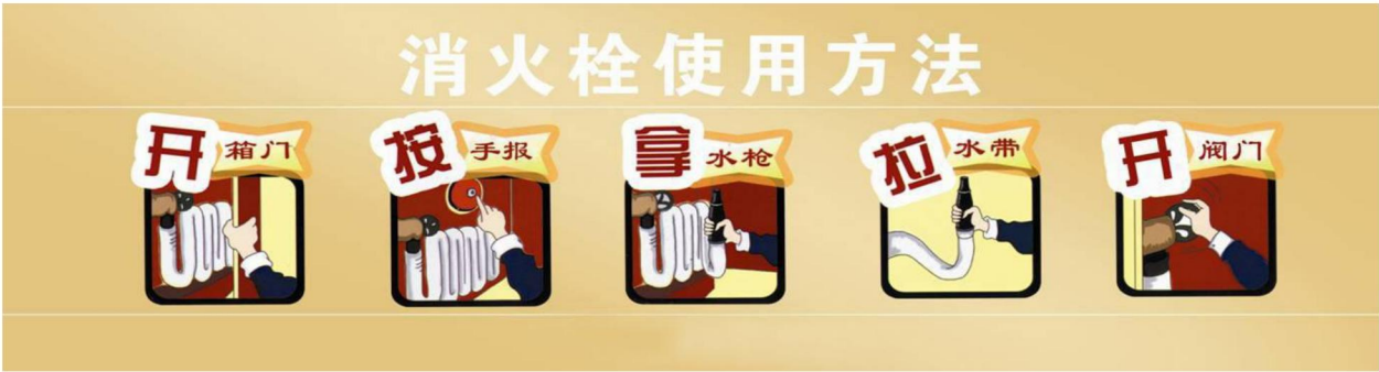
图A.2 消火栓使用方法
