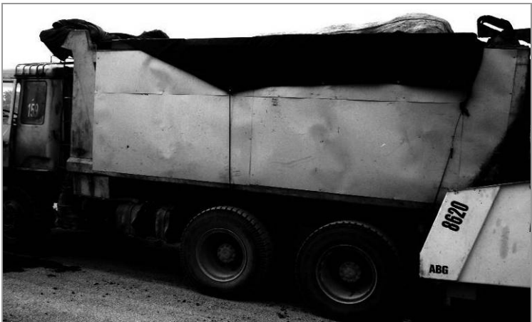
图G.14 运料车采取严密的覆盖措施
