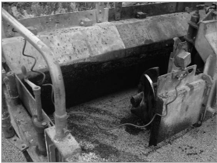
图G. 11 螺旋输送机过短
