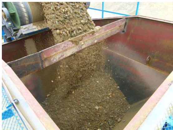
图G. 3 拌和机出料口处设置挡板示意图
