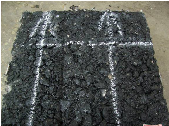
图C. 4 AC-20 车辙碾压深度照片
