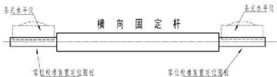
图A.3 用条式水平仪校准前（后）端左、右测量传感器定位圆销的轴线（铅垂方向）平行度示意图
