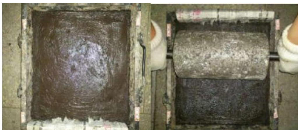
图A.4 稀浆封层型成型与碾压
