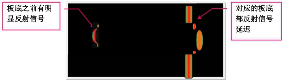
图C.4 空洞型缺陷的云图（色板-4，铁皮波纹管）
