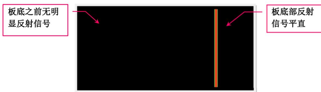
图C.1 健全部位的云图（色板-1）
