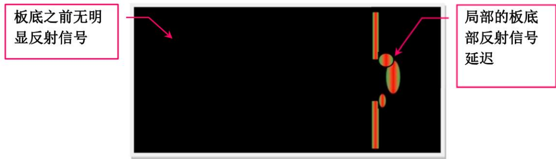
图C.3 松散型/小空洞型缺陷部位的云图（色板-3）
