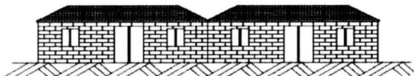
图 3.2.5-2 结构不连续的平房划分为两个编码单元示意
