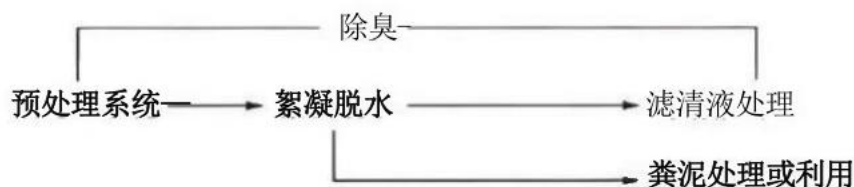
图4.0.5-1 粪便絮凝脱水处理工艺示意图
