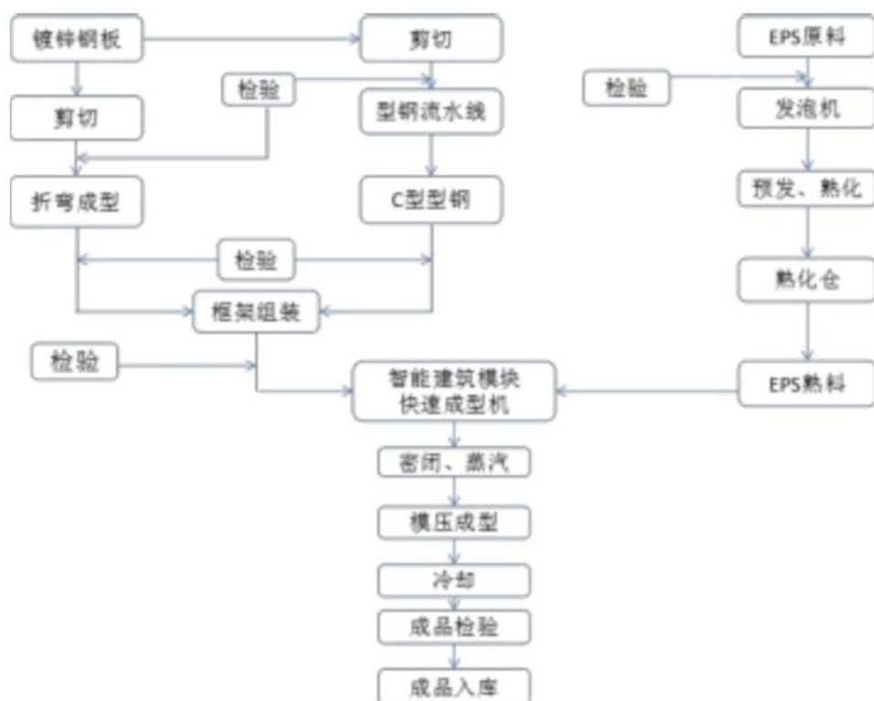
图 12 钢骨架塑塑墙板的生产工艺流程
