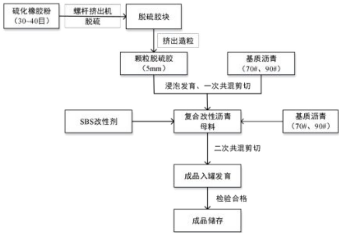
图 1 SBS-胶粉复合改性沥青加工流程图
