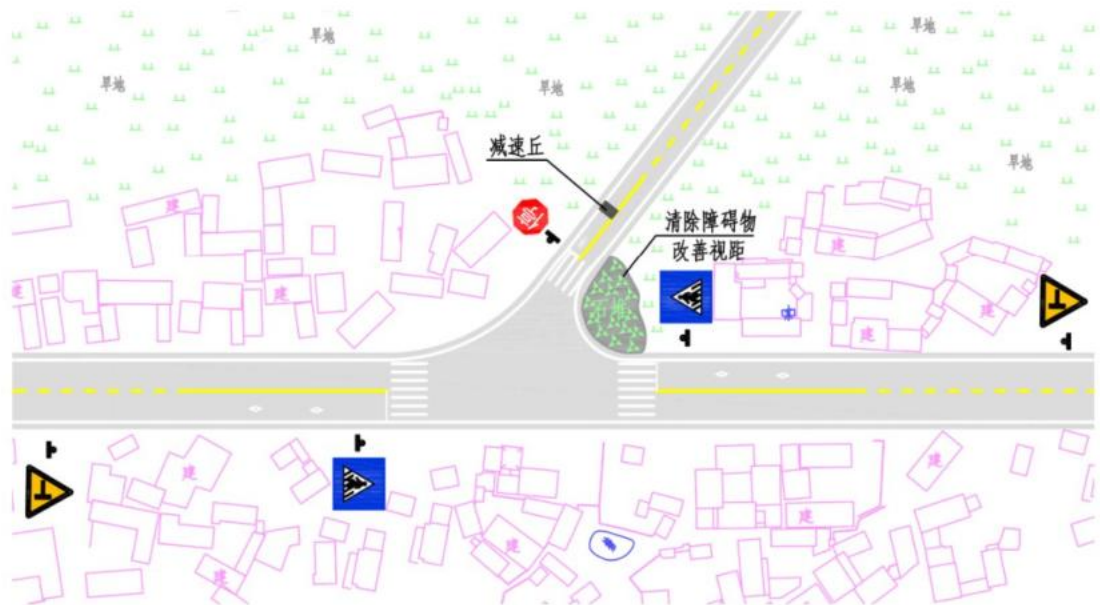
图C.6 平面交叉口路段处治示例
