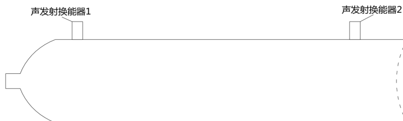
图 1 气瓶声发射检测换能器布置示意图
