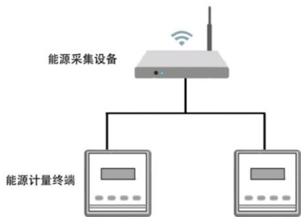
图1 能源数据采集系统架构
