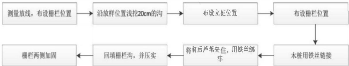
图1 芦苇栅栏施工流程
