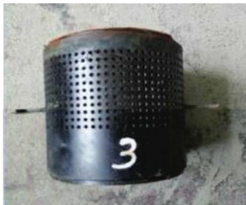
图 D.1 侧面泡水 CBR 试筒
