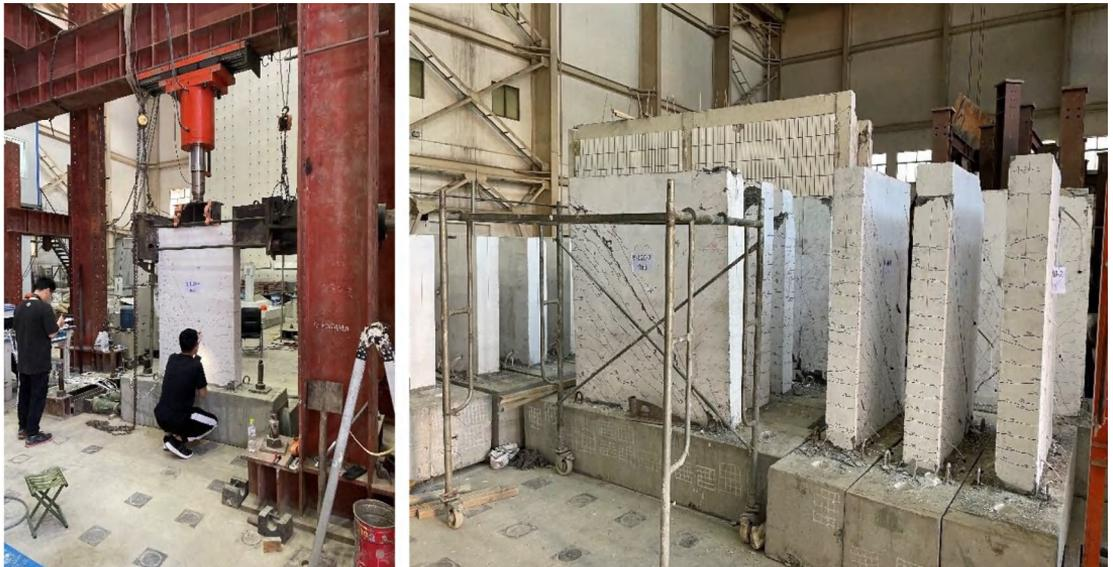
图2 钢丝网片组合板保温体系低周往复荷载下抗震试验
