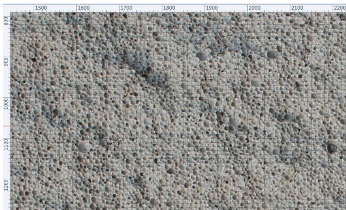
图C.1 表观气孔分布均匀、细密（最大等效孔径 d_e \leq 1.0\text{mm} ）
