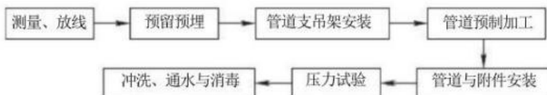
图6.1.2 室内给水系统安装工序
