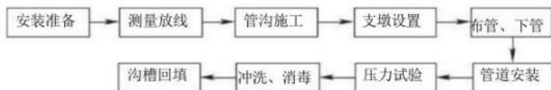
图11.1.2 室外给水管网安装工序
