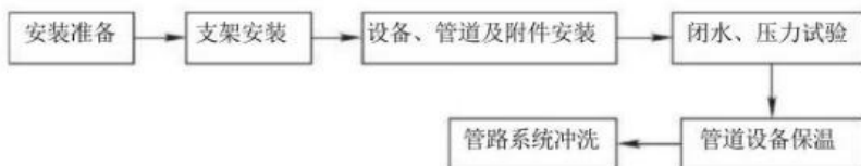
图8.1.3 太阳能热水器及管道安装工序
