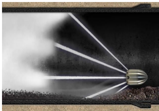
图 6.2.1 喷射铣头工作示意图
