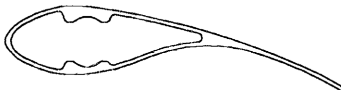
图 A.1 挤拉截工艺成型的轴流风机叶片图
